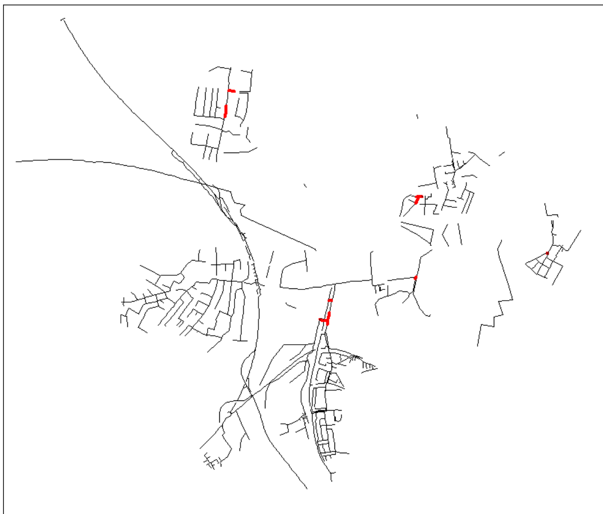
Obr. 5.25 - Vyhodnocení přetížení stokové sítě dešťové kanalizace pro P = 0,1 N=10 (desetiletý déšť). Varianta bez limitu vypouštění.
