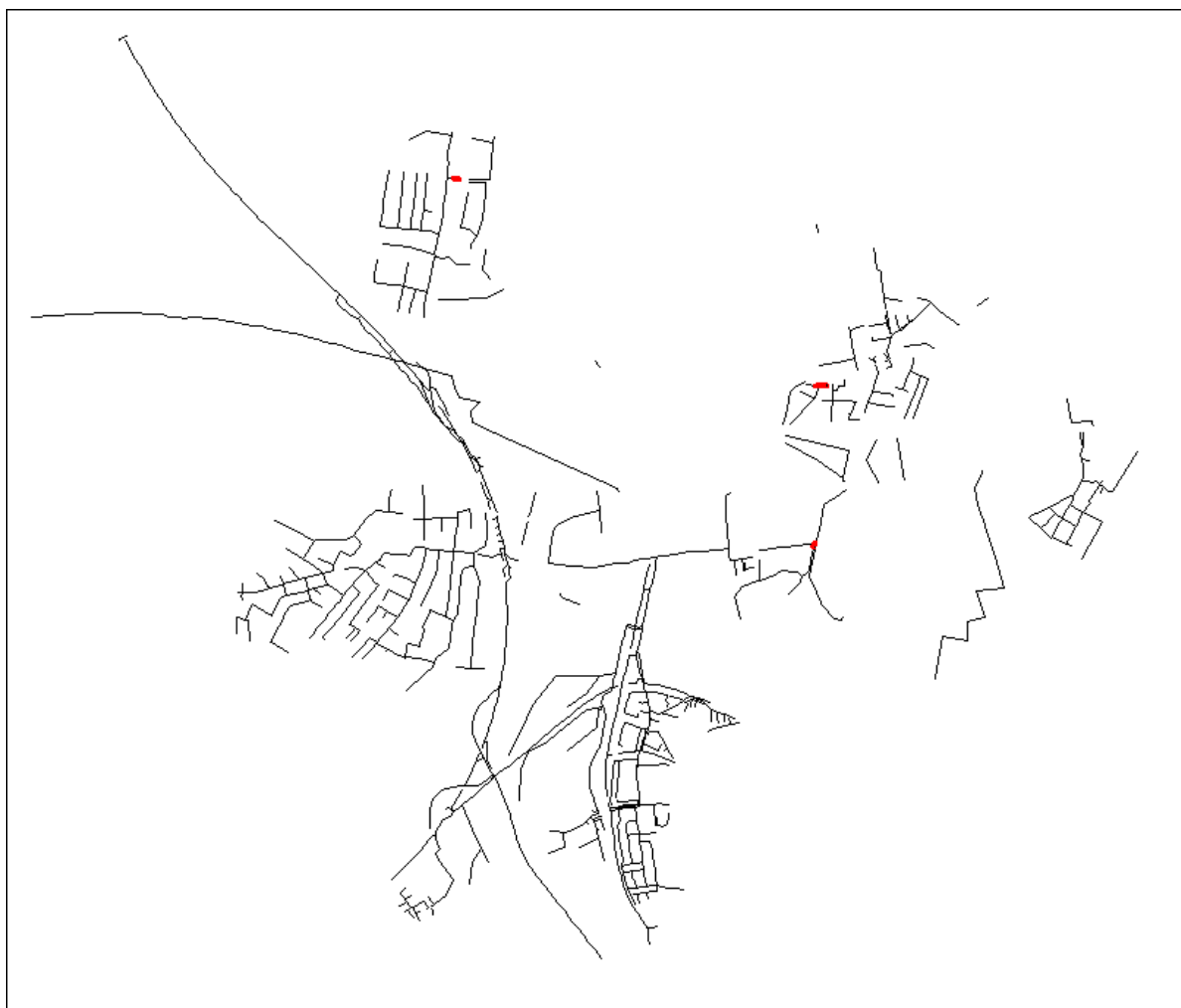
Obr. 5.23 - Vyhodnocení přetížení stokové sítě dešťové kanalizace pro P = 0,5 N=2 (dvouletý déšť). Varianta bez limitu vypouštění.
