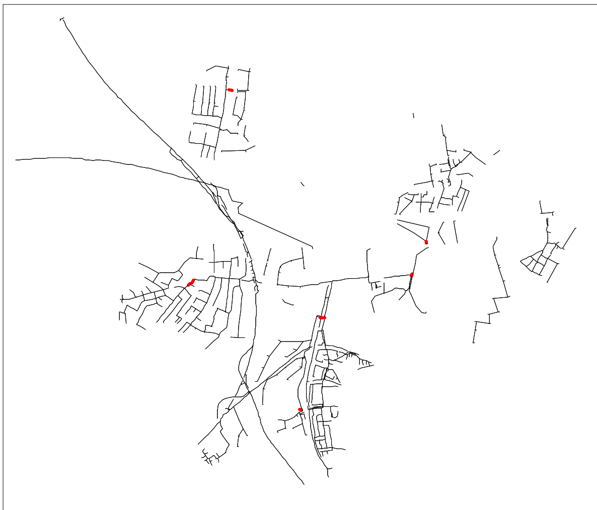
Obr. 5.17 Vyhodnocení přetížení dešťové stokové sítě pro P = 0,1 N=10 (desetiletý déšť). Varianta s limity vypouštění. Stav po navržených rekonstrukcích.
