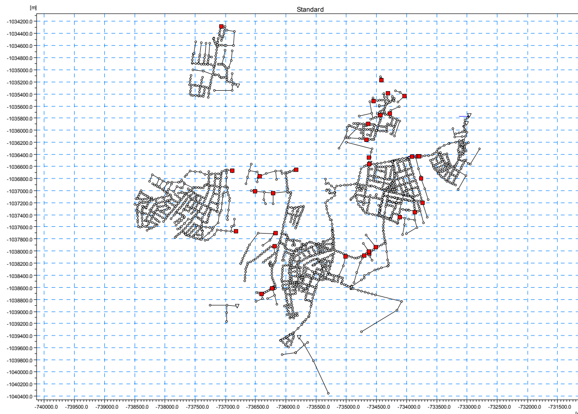
Obr. 3.8- Matematický model jednotné a splaškové stokové sítě pro výhledový stav
